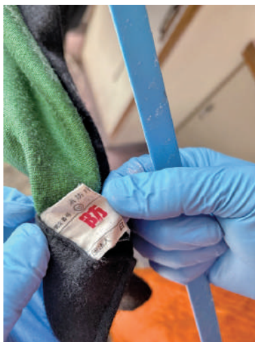
カーテンに貼付されていた防災ラベル
