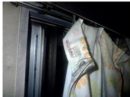
写真8 焼損した防災カーテンの状況
