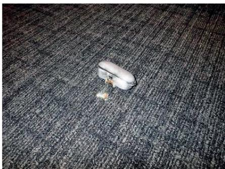
写真3 焼損したワイヤレスイヤホンの状況
