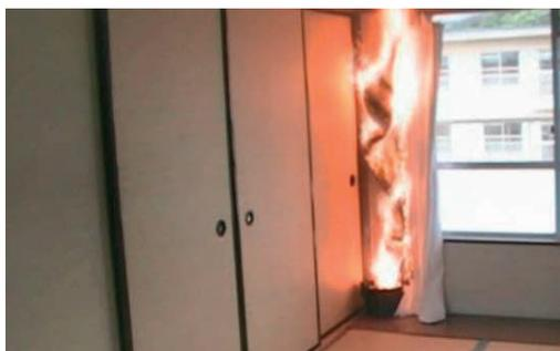
写真2 カーテンに着火してから10秒後の状況
