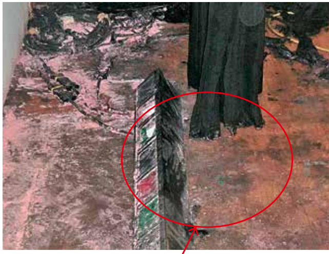
火災発生場所の舞台照明装置と防災製の舞台幕
