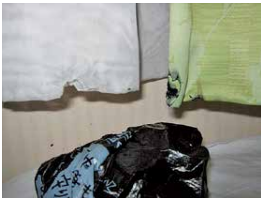
延焼を防いだカーテンの焼損状況
