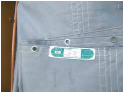
写真6 防災ラベルを確認
