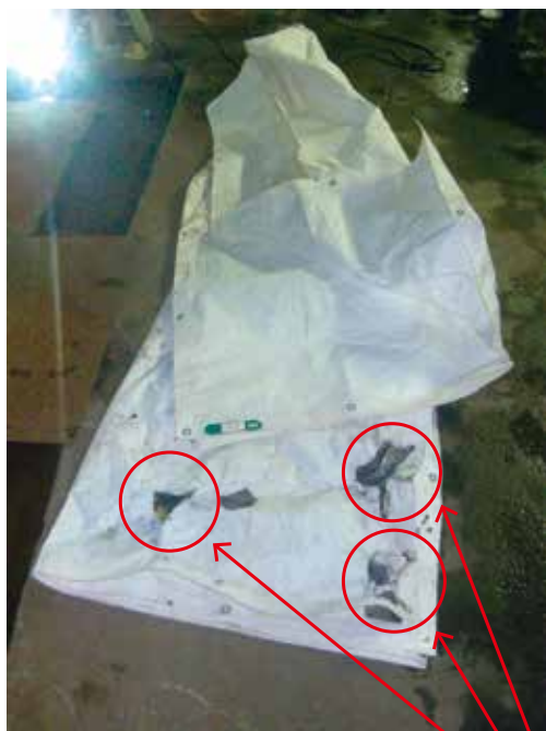
防災シートの焼損箇所
