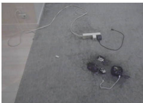
カーペット及びモバイルバッテリーの焼損状況
