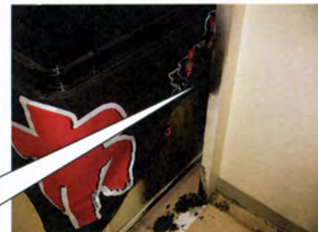
陳列台の上で使用されていた防災製品の幕（テトロンボンジ（ポリエステル100%）） 平成16年9月に納品 認定番号 F10034
