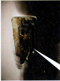
コンセントと差し込みプラグの隙間に幕が接触した位置
