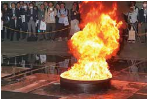
軽油の燃焼実験 [消防研究センター]
