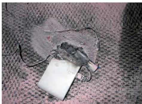
リチウムイオン電池の破裂の状況
