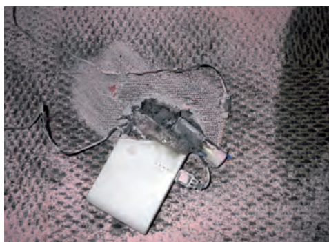
リチウムイオン電池の破裂の状況
