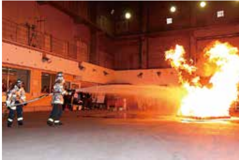
可燃性液体火災の消火実験
